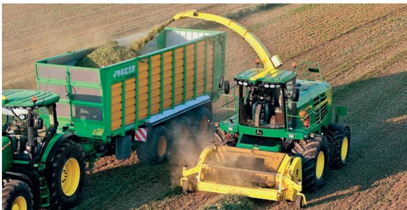
Комбайн John Deere 7480 эксплуатируется при заготовке сенажа из валков (с подборщиком шириной от 3 до 4,5 м), кукурузного силоса и зерносенажа (с универсальной рядонезависимой жаткой с шириной захвата от 4,5 до 7,5 м), а также может использоваться в зимний период для уборки кустарника с целью получе-
